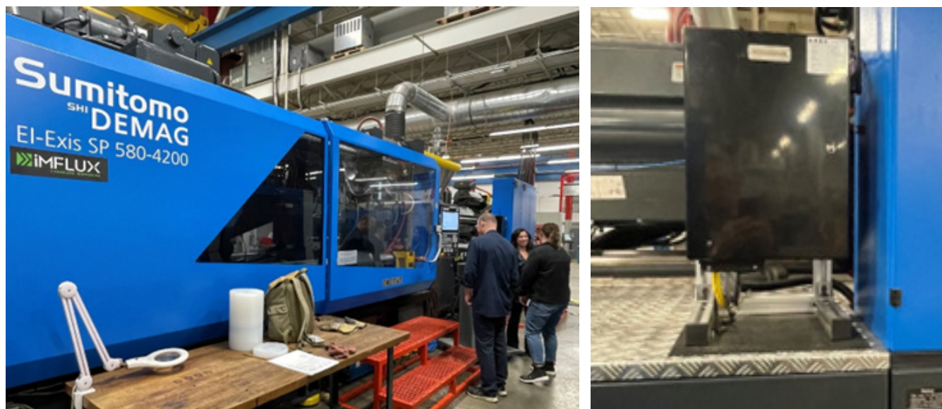
Máquina de prueba StackTeck equipada con unidad de control iMFLUX (a la derecha)
