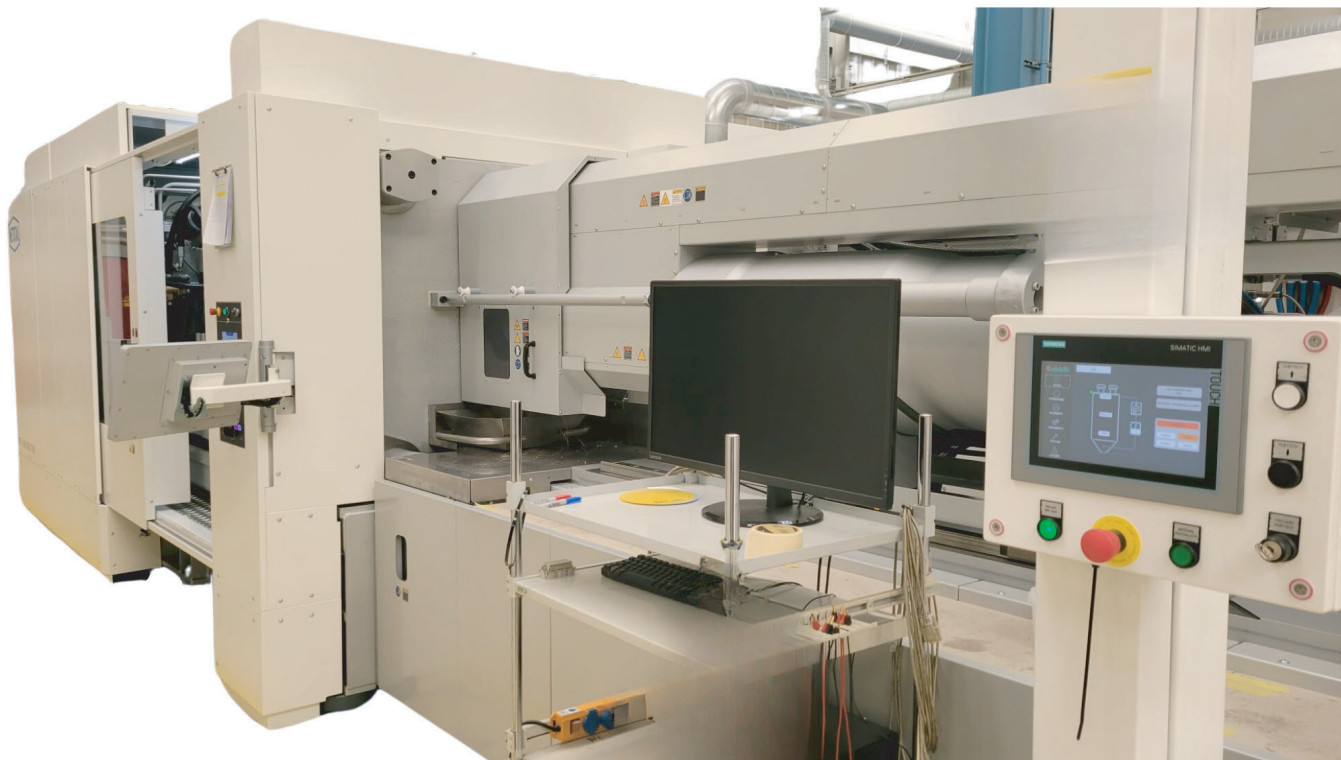
Sistema de preformas de PET NETSTAL PET-LINE 5000 con automatización de entrada lateral. Se instalará un sistema equivalente en StackTeck TeckCenter en septiembre del 2024.
