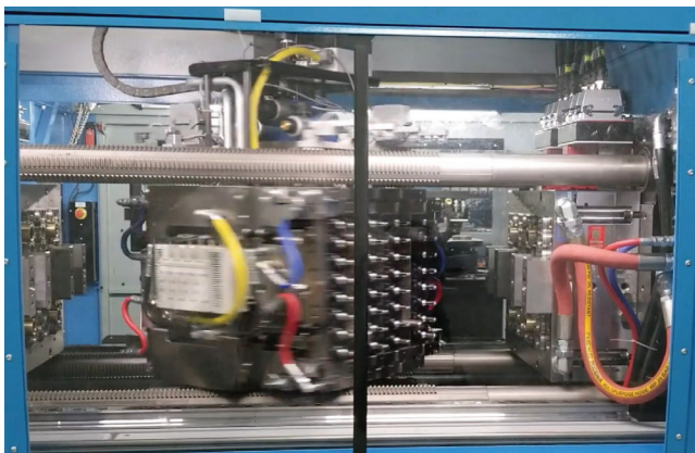
Molde de cubo mientras gira en la máquina
