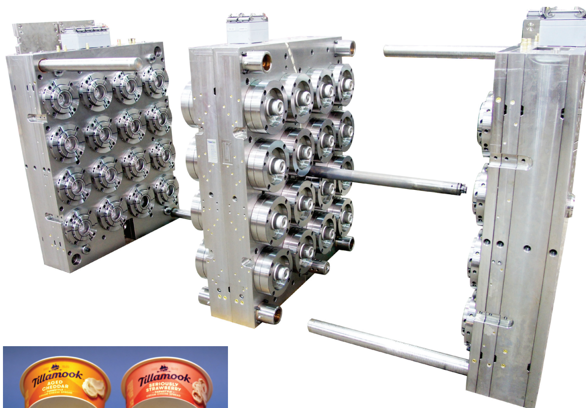
Molde para Vaso IML de 2x16
